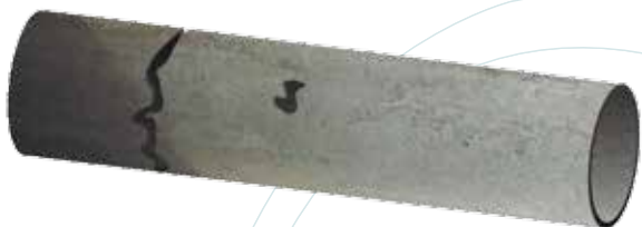
Greta, rotura ou parede deteriorada
