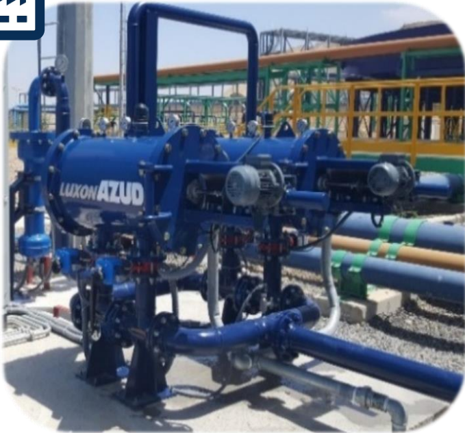
2 x AZUD LUXON LXE 2700 S/4 30 m 3 /h | 50 μm | Marruecos Coca-Cola fábrica embotelladora
